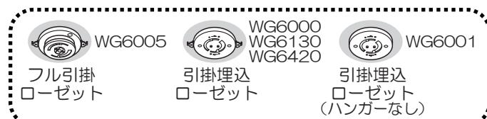
※ [ ] の配線器具を使用する場合は付属部品のスペーサBをスペーサAへ必ず取り付けてください。
