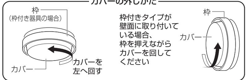
枠付きタイプが壁面に取り付いている場合、枠を押えながらカバーを回してください
