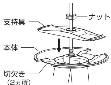
②本体の切れき（2ヵ所）にカバー開口部を沿わせながら、カバーを取り付ける。
