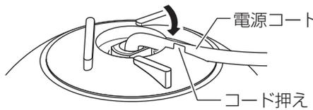
**確認** 電源コードが台から飛び出していないことを確認する。
