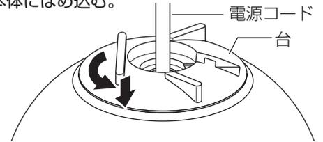
③ 電源コードを持ち本体を持ち上げた状態でナットを右に回して締め付ける。
