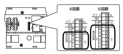
※負荷切替スイッチはプレートを外した 左図の位置にあります。 設定の際は細いマイナスドライバーなど で設定してください。
