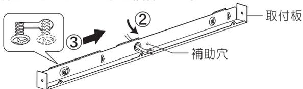
④ 反対側の長穴を木ネジで締め付ける
