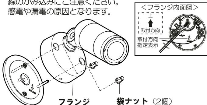
袋ナット（2個）を工具で確実に締め付けてください
