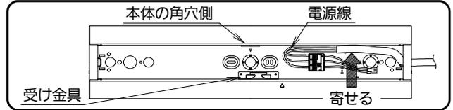
**不備があると電源線損傷による感電・火災の原因となります。**
