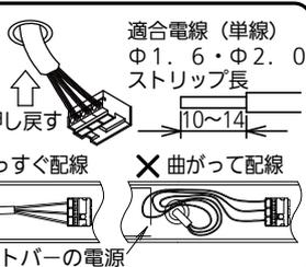
**不備があるとライトバーの電源と干渉し電源線損傷による感電・火災の原因となります。**
