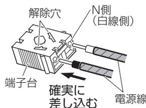
器具の取り替え等で電源線を外す場合は、マイナスドライバー等を解除穴に差し込みながら電源線を引き抜く。
