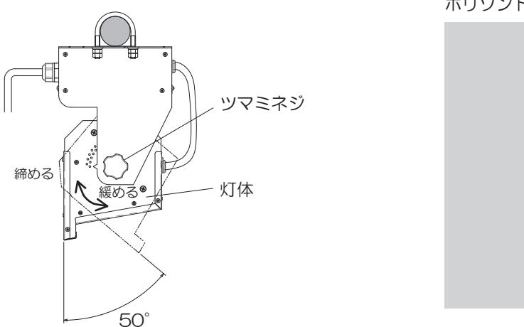
※ツマミネジを軽く緩めた状態で照射角度を調整された場合、復元力により所望の照射角度からずれる恐れがあります。
