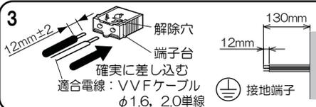
電源線の外しかたマイナスイドライバーなどで解除穴を押しながら電源線を引き抜く
