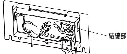
注) 取付板の曲げ部に線がかからないように収納してください。
