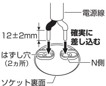
器具の取り替え等で電源線を外す場合は、 $\phi 1.6$ の単線をはずし穴に差し込みながら電源線を引き抜く。
