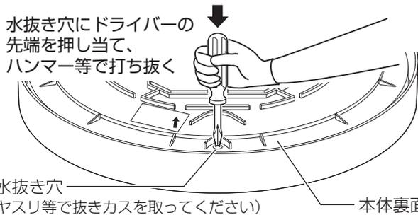
・穴開け後、本体の内側から水抜き穴に、付属の防虫シールを貼り付けてください。
