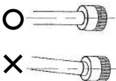
①の注意点 : 給電側ソケットの回転部分が下図の位置にあることを確認する。
