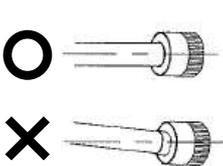
⑤の注意点：給電側ソケットの回転部分が下図の位置にあることを確認する。
