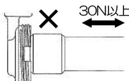
③の注意点 : ソケットキャップとソケットにスキマが出ないように締め付ける。(中途半端締め付け、斜め締め付けをしない。)
