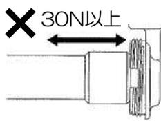
⑦の注意点：ソケットキャップとソケットにスキマが出ないように締め付ける。
