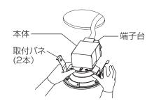
●傾斜天井に取り付ける場合は、傾斜方向の上下に 取付バネがくるように取り付けてください。 上記以外の方向で取り付けた場合、器具ズレ、 ガタツキの原因となることがあります。
