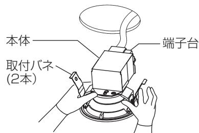
●傾斜天井に取り付ける場合は、傾斜方向の上下に取付バネがくるように取り付けてください。
