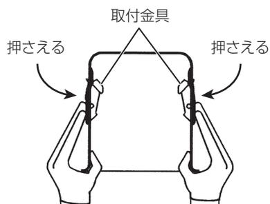
③ 取付用矢印が、所望する投写方向に向いていることを確認し、枠部分が天井に当たるまで、ゆっくりと差し込む。
