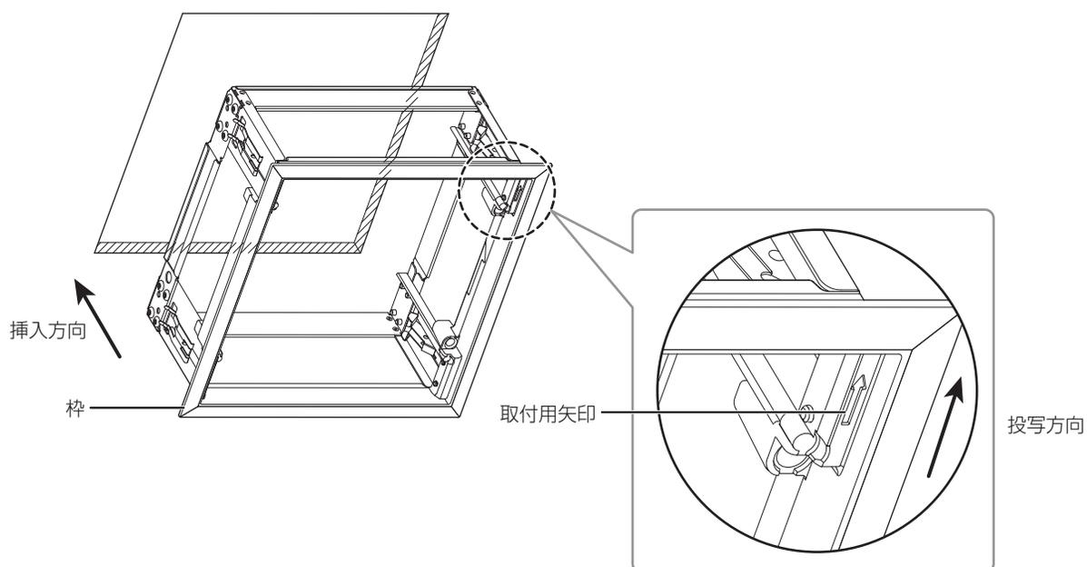
④ 取付金具(4カ所)を引き下げて、埋込枠を確実に固定する。
