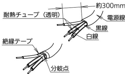
分岐点・余分な電線が器具外部に戻されている
