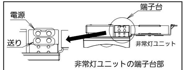
④非常灯用電源線を直角に曲げて、本体の電源穴直下で垂直になるように位置を整える。
