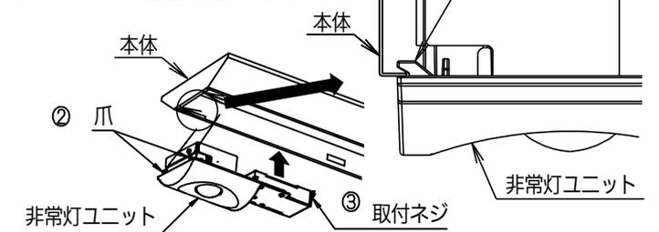
④非常灯ユニットを矢印の方向に押しながら、取付ネジを確実に締め付ける。
