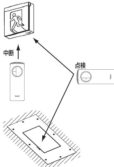
器具近傍からリモコンを操作しない場合、隣接する器具も受信してしまうことがあります。その際は、隣接する器具の近傍からリモコンの中止ボタンを押して点検を中断してください。
