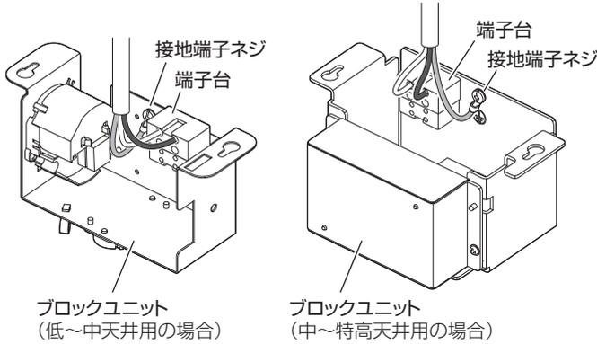
アース線のかみ込みを防ぐため、線の向きに注意して接続してください。(左図参照)
