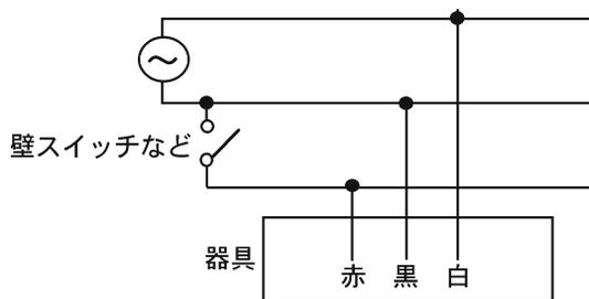
※器具端子台の短絡線を取り外して結線してください。
