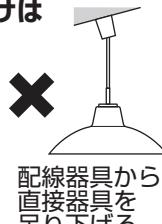
配線器具から直接器具を吊り下げる
