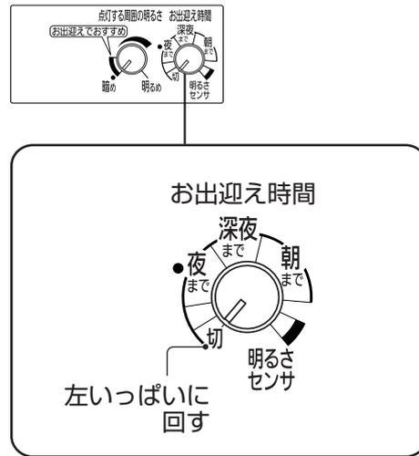
3 「点灯する周囲の明るさ」 ツマミでどれくらい周囲が暗くなったら、人が近づいたとき点灯させるかを設定する
