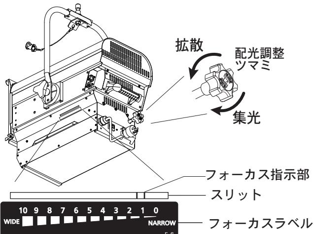
配光の調整は、灯体後部の配光調整ツマミを回転させて行ってください。
