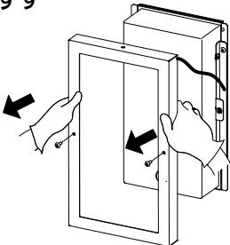
枠取付ネジ（2点）をゆるめて、枠をはずす。
