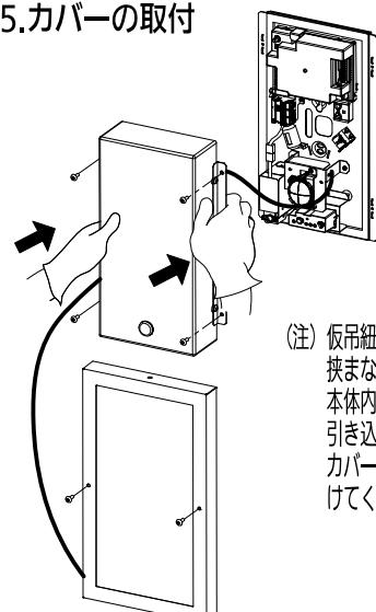
カバーをカバー取付ネジ（4点）にて本体に取り付ける。
