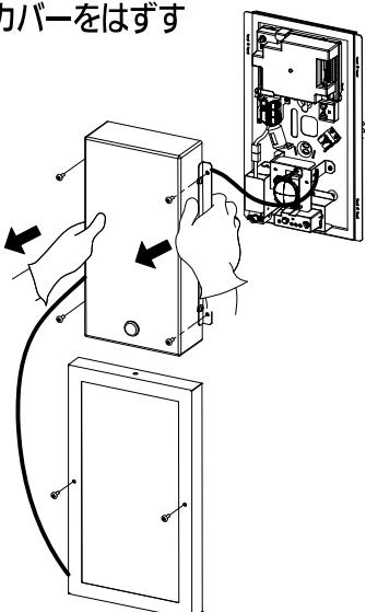
カバー取付ネジ（4点）をゆるめて、カバーをはずす。
