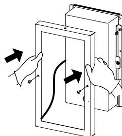
(注) 仮吊紐を枠に挟まないように枠内部に紐を引き込んでから枠を取り付けてください。
