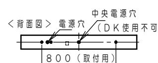
電源線を中央電源穴から引き込む場合には、耐熱チューブを半分（約150mm）に切断し、電源線のシース部を約150mm剥いて使用しても問題ありません。
