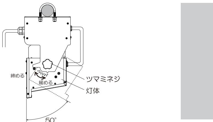
※ツマミネジを軽く緩めた状態で照射角度を調整された場合、復元力により所望の照射角度からずれる恐れがあります。
