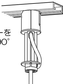
**確認** 取り付け後、ストッパーを下げずに回し、外れないことを確認してください。
