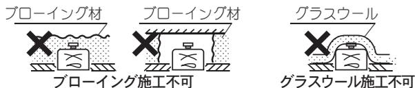
器具は断熱材・防音材・造営材等と下図のような空間を設けて施工してください
