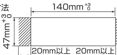
壁面パネル内の斜線範囲に野縁や金属等の障害物がないようにしてください。
