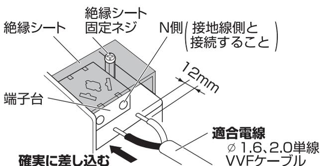
●絶縁シートは取り外さないでください。電源線を外すために取り外した場合は、取り付け直してください。
