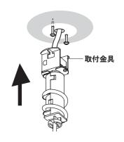
②取付金具の切り欠きを 木ネジに引っかけるように スライドさせる
