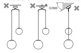
補強のない薄い場所 不安定な場所 32度を超えて (ベニヤ板や石膏ボードなど) 傾斜した場所
