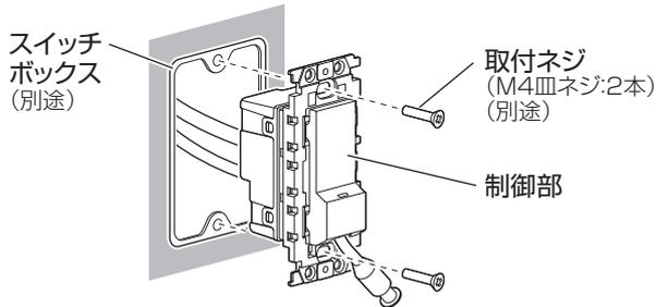
注) 下側の取付ネジを締め付ける際はコネクタのケーブルを工具等で傷付けないようにご注意ください。
