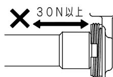
⑦ の注意点：ソケットキャップとソケットにスキマが出ないよう締め付ける。(中途半端締め付、斜め締め付をしない。)
