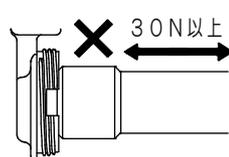
③の注意点: ソケットキャップとソケットにスキマが出ないよう締め付ける。(中途半端締付、斜め締付をしない。)
