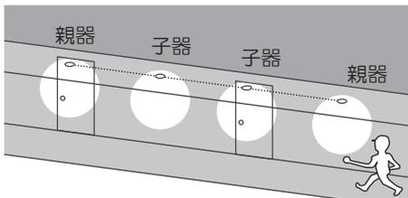
2台のセンサ付き器具（親器）の間にセンサなし器具（子器）を接続。
