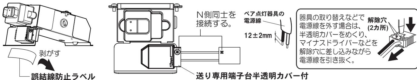
器具の取り替えなどで電源線を外す場合は、解除穴(2カ所)半透明カバーをめくり、マイナスドライバーなどを解除穴に差し込みながら電源線を引き抜く。
