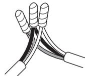
圧着スリーブ等で結線後、テーピング処理する
