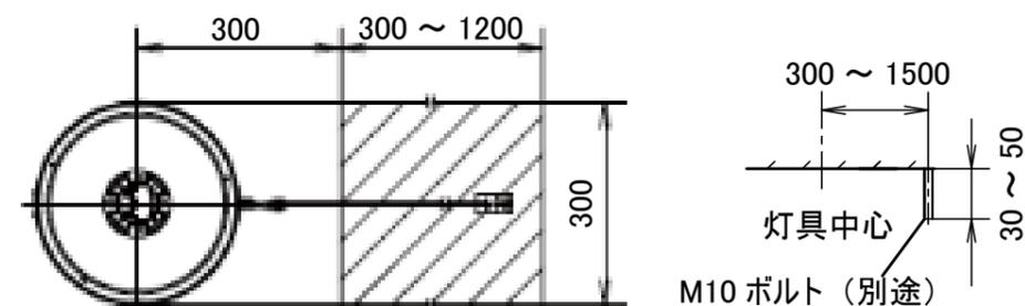
※落下防止ワイヤー用取付ボルト(別途)は、灯具取付面と同じ、または上の高さになるように設置してください。
