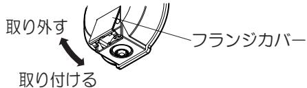
フランジカバーは必ず取り付けて使用してください。フランジカバーを取り外したまま使用すると、水が浸入し、感電・故障の原因となります。
