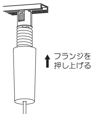
ランプをソケットに確実に取り付ける。
