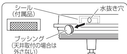
注) タイル面など取付面に凹凸がある場合は、取付面と本体パッキンとのすき間を防水シール材などで埋めてください。
