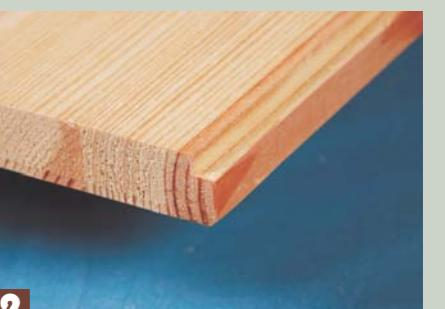
2 側板のダボ打ちする位置にスミ入れし、左右の側板(後ろ側)と天板・底板(後ろ側)に5角の合いガキ(角を落とすこと)をとる。こうすると背板のボードをぴったりはめることができる。(同じように、ガラス扉の内側にもガラスをはめるための合いガキをとる。合いガキをとる工具はケガキルーターを使う)
