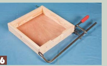
6 ドレーベル(本体を乗せる土台部分)の左右を角度定規で45度に切り、木工ボンドで額縁状に接着して、粘着テープで固定する。
