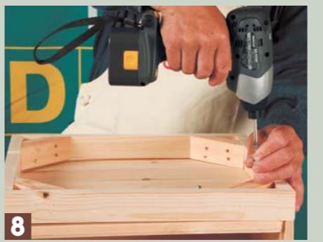
8 本体と台輪を取り付け、背板を木工用ボンドとクギで取り付け、その後で中仕切り板を取り付ける。
