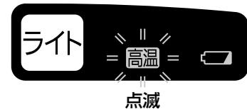
作業を中断し、約30分以上放熱させ、高温お知らせランプが消灯してから使用してください。また、保護機能がくり返し働くような作業は行なわないでください。
