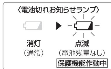
リチウムイオン電池は過放電状態になる(カラまで使う)と電池の寿命が大幅に劣化します。過放電防止のため、電池を保護する機能を搭載しております。
