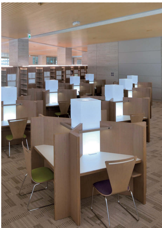
さまざまなバリエーションの閲覧デスクに組み込まれたLEDの光は、タスク照明としての機能と、天井面を照らすアンビエント照明の機能を両立している。
