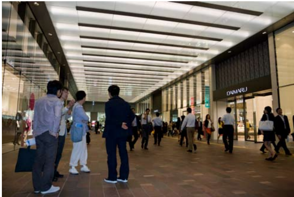
東京駅構内と外を繋ぐ「ノースタワー」のモール。天井の照明にはライトチューブと乳白ガラスが組み合わされ、人通りの多い空間に面の光をつくり出している。
