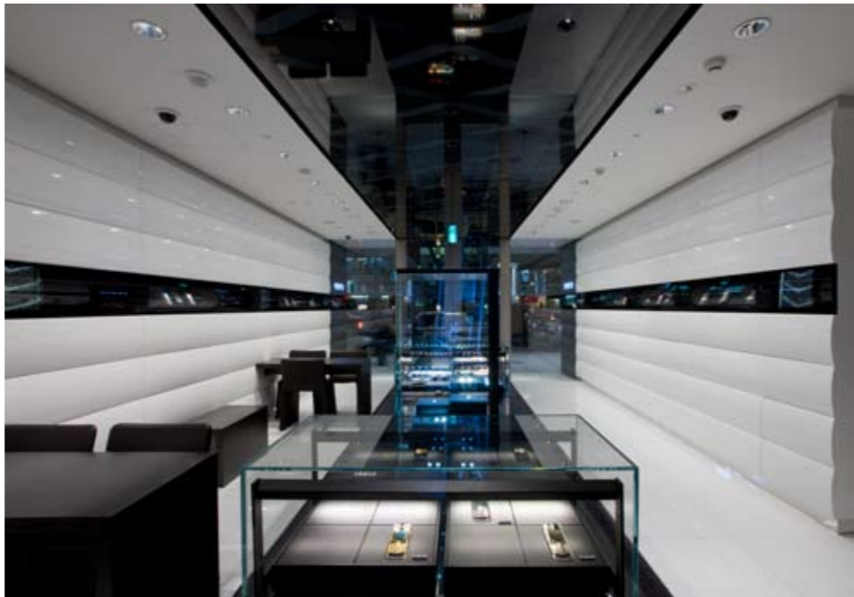
ラグジュアリー・モバイルフォンのVERTUの旗艦店。1階内部より前面道路を見る。センターディスプレイ上、ガラスショーケース内のLED照明はゴールドやシルバーといった商品に合わせて色温度が調整されている。両側のフィーチャーウォールはウレタン塗装鏡面仕上げ。
