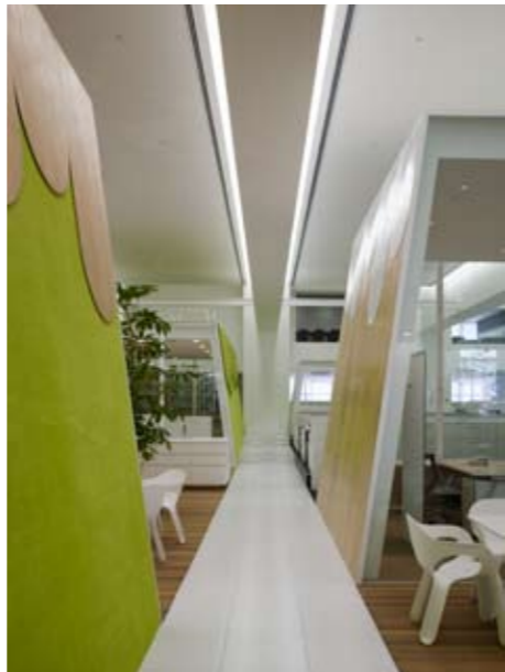
照明は梁の両側に配置し、反射する光によって空間がより明るく感じられるようにしている。照明横に空調吹き出し。
