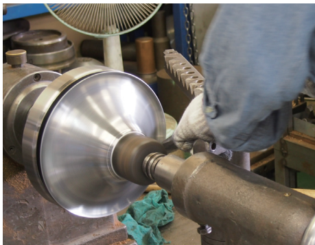
へら絞りの様子。「へら」を使って、回転するアルミ板を金型（雄型）に押し当て、反射板を成形する。下記URLからへら絞りの様子を紹介する製造工程の動画が見られる。
